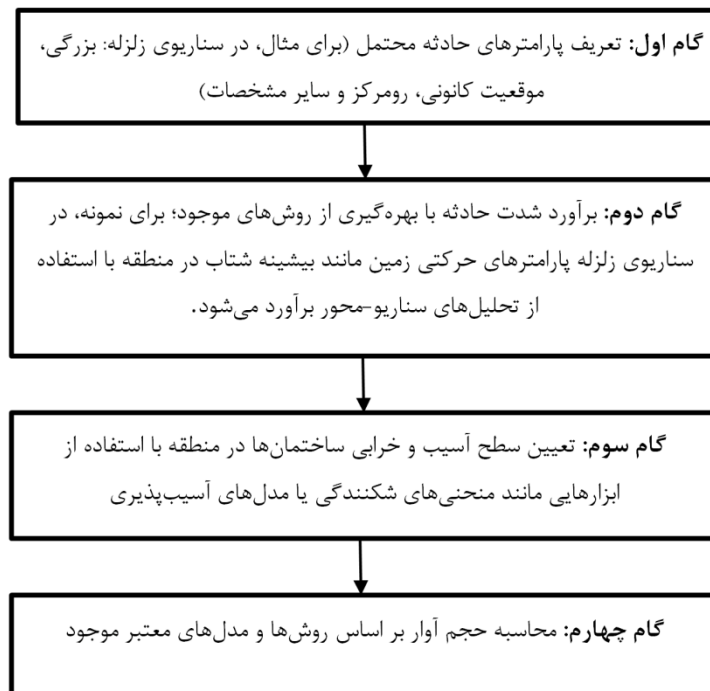
شکل ۲-۱: الگوریتم چهار مرحله‌ای تخمین حجم آوار ناشی از بلایای طبیعی
